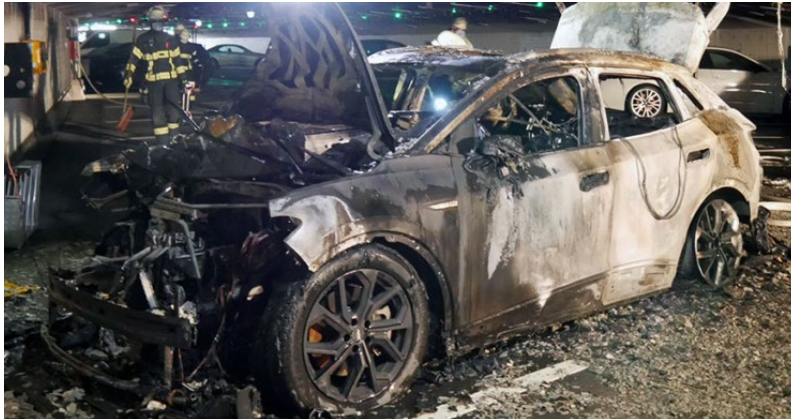
Figuur 2.4 Uitgebrand EV parkeergarage Ravensburg (Pichler, 2021)
