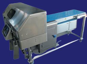
Procesamiento de ensaladas, extracción del corazón y cortado
