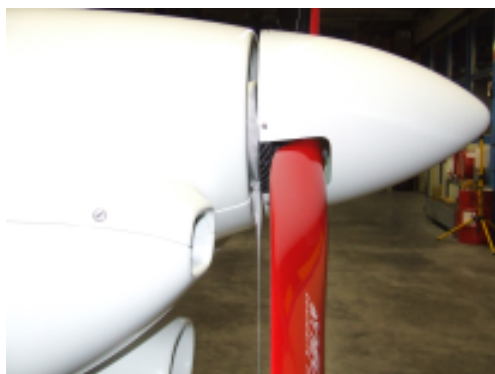
Point de fixation entre le plateau d'hélice et le capot moteur.
