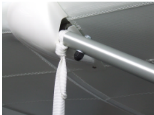
Point de fixation sur le hauban avant illustré sur l'image.
