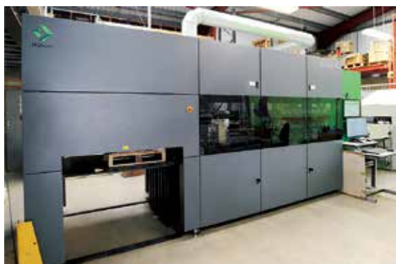
Arriba: muestra de corte láser con el sistema Highcon; abajo: sistema de corte y hendido digital Highcon Euclid III
