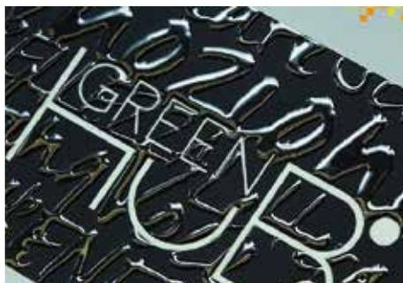
hemos ampliado la gama de materiales sobre los que podemos imprimir: la máquina permite imprimir desde 0.06 hasta 0.6 mm en modo directo, y hasta 0.45 mm a doble cara. Además, gracias al curado UV LED, podemos imprimir sobre materiales plásticos, y especialmente sobre papel natural, que los clientes suelen preferir antes que su homólogo brillante.
