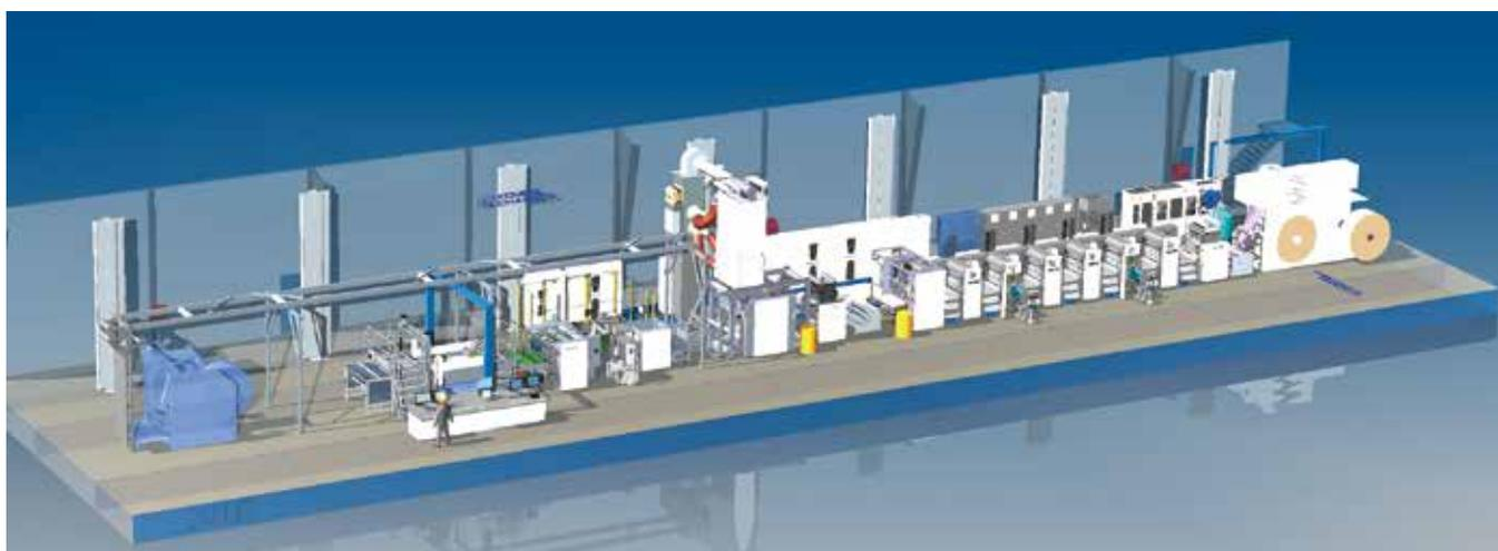
La línea de producción de KCM, desde la desbobinadora hasta la salida en una configuración típica de derecha a izquierda. KCM domina todos los procesos de impresión y puede combinarlos, como en este caso con una unidad de flexografía tras las unidades offset para la gestión del barniz.
