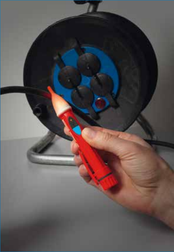
Yalıtılmış ve yük altındaki hatlarda kablo kopukluklarının tespit edilmesi
