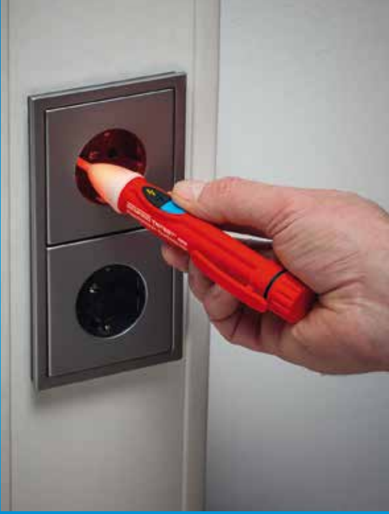
Kablolu çıkışlar ve junction boxlarda faz testi cihazı
