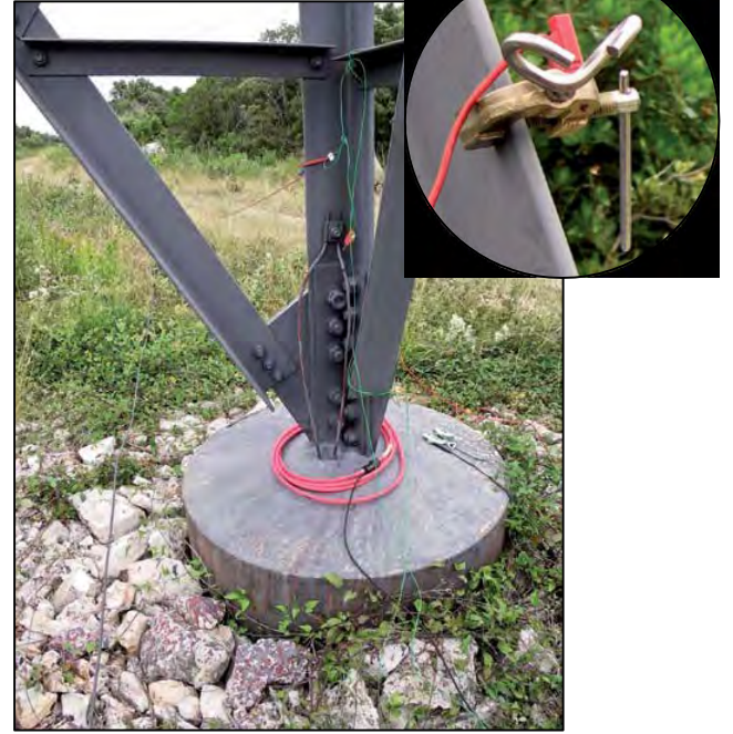
AmpFLEX™ sensör ile her türlü direkte ölçüm yapılabilir.
