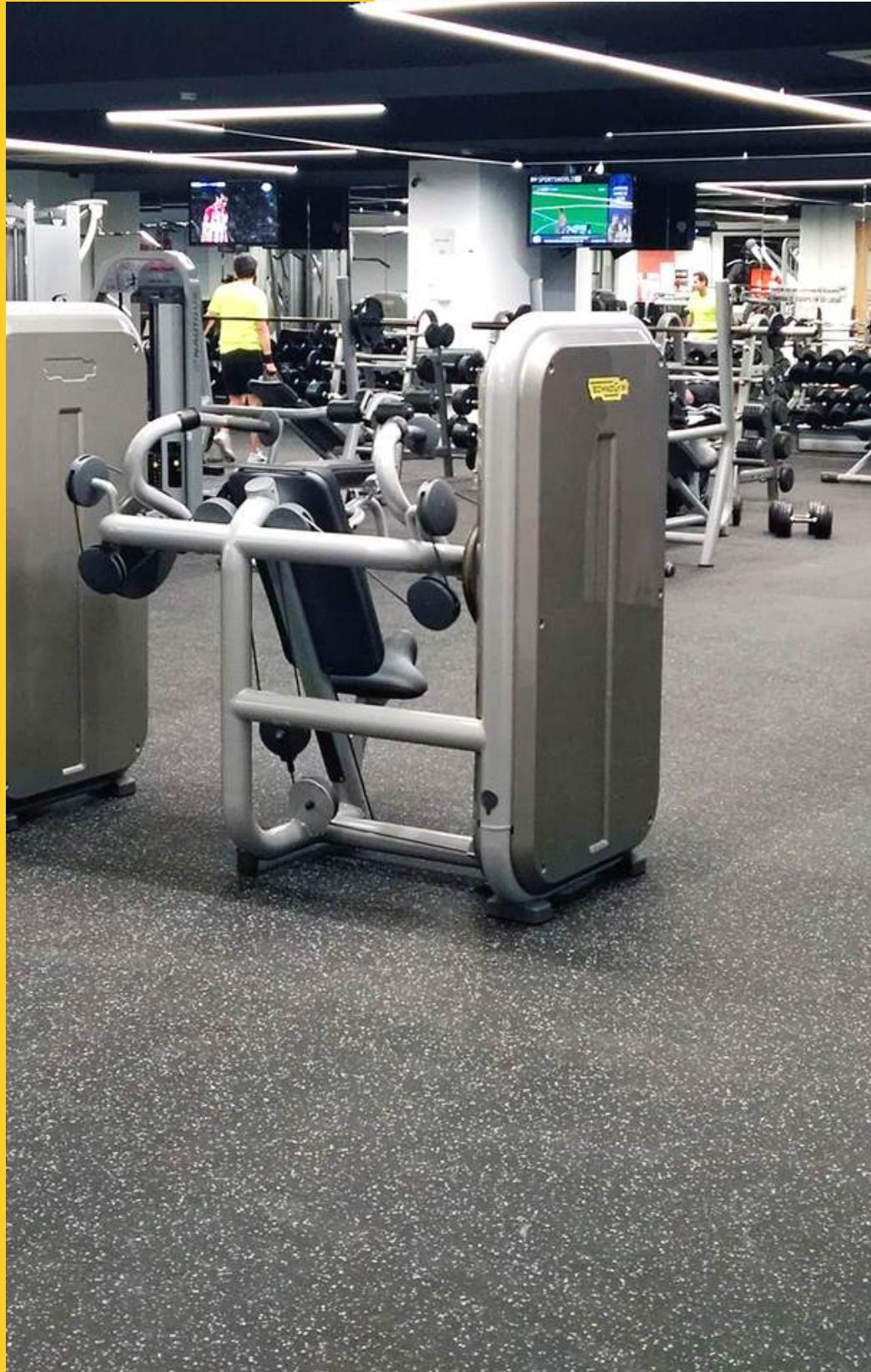
Nuestro piso de caucho fabricado con caucho reciclado compuesto (SBR) que provee una superficie duradera, resistente y a precio competitivo. Piso de muy bajo mantenimiento, fácil de instalar es la opción ideal para proyectos deportivos.
