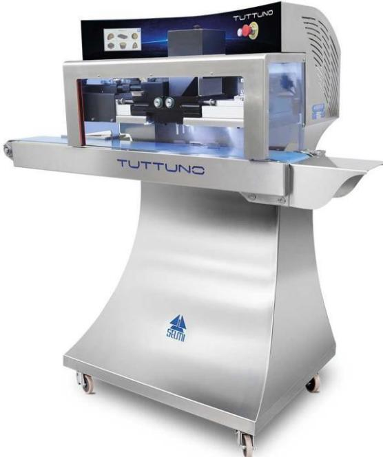
Máquina dispensadora simultánea destinada a la creación de productos rellenos en una sola operación, incluyendo pralines en moldes de policarbonato, bolas, huevos y productos con características especiales.
