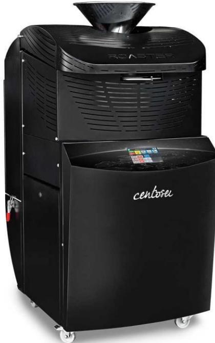
"Roaster" fue diseñado para trabajar en un ciclo continuo de procesamiento automático. Tiene una capacidad de 6 Kg y puede tostar 40 Kg de café o fruta seca por hora.
