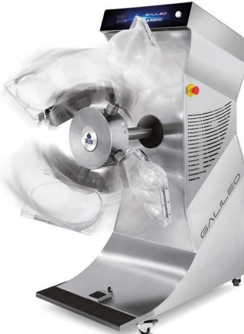
Esta máquina, está construida enteramente en acero AISI 304, permite fijar el molde sobre dos imanes permanentes. Está equipado con un mecanismo de embrague de seguridad y permite el uso simultáneo de 4 espacios de trabajo.
