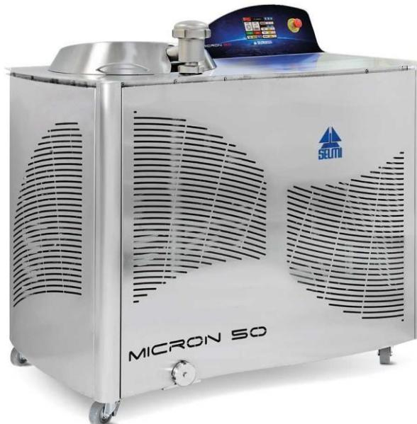
El refinador de bolas Micron fue diseñado para la producción de cremas para untar, pastas anhidras para helados, productos pralinados y dulces cremosos. La máquina está equipada con un refrigerador con el fin de regular, dentro de los límites establecidos, el exceso de calor causado por la fricción generada entre las esferas.
