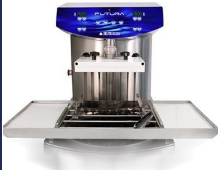
Base universal con fijación rápida para el templado. Placa con boquillas intercambiables. Red de distribución interna. Calefacción autónoma de auto-regulación en dos resistencias de bajatensión. Los carriles mesa vibratoria molde montado
