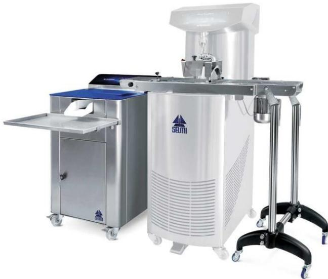
Esta cinta de cobertura de dos secciones presenta vibraciones mecánicas para ayudar la cobertura de chocolate con una tolva de recubrimiento de chocolate de velo doble.
