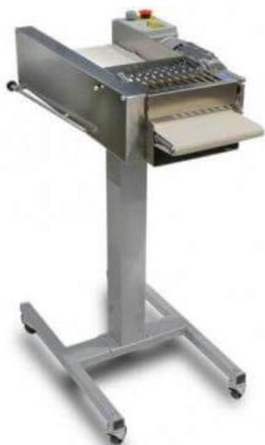
ROLLER es una máquina enrolladora para croissant capaz de formar rápidamente (1800 piezas/hora) cruasanes y productos similares simplemente posicionando los triángulos de masa (grosor de 3 a 8 mm) sobre la pertinente cinta transportadora.
