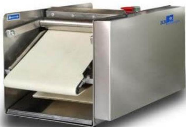
ROLLERO es una máquina enrolladora para croissant capaz de formar rápidamente (1800 piezas/hora) croissant y productos similares simplemente posicionando los triángulos de masa (grosor de 3 a 5 mm) sobre la pertinente cinta transportadora.
