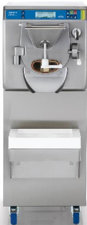
Modula de forma dinámica gas frío y gas caliente optimizando el intercambio de temperatura durante la mantecación..
