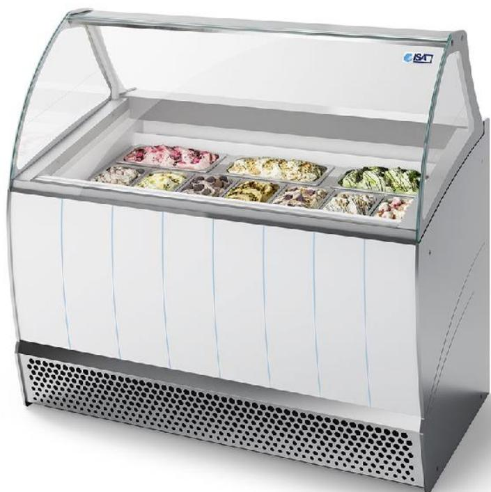
Vitrina de heladería con sistema de refrigeración ventilado y descongelación automática por gas caliente, que está equipada con una celda de almacenamiento en el sótano con sistema de refrigeración estática. Estructura de la carrocería con aislamiento de poliuretano ecológico (libre de HCFC y HFC) espumado con CO2
