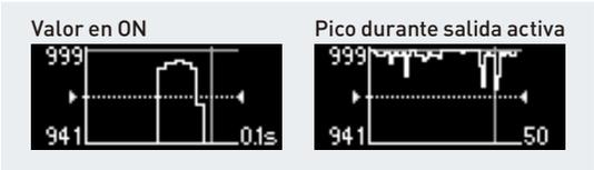
La combinación de un OLED y un indicador de 7 segmentos le permite a los usuarios ver rápidamente los datos en tiempo real. El MU-N también tiene la capacidad de mostrar gráficos en vivo, para un monitoreo sencillo de la máquina.
