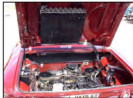
EM w/AC - note condenser location!
