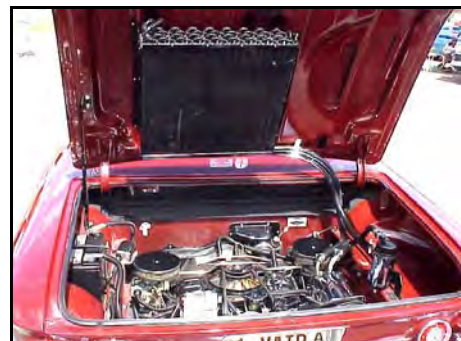
EM w/AC - note condenser location!
