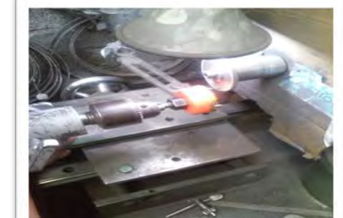
Paso 6. Afilado de pastillas con Angulo de 35%
