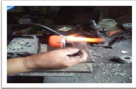
Paso 3. Soldado de pastillas de carburo de tungsteno (WC)
