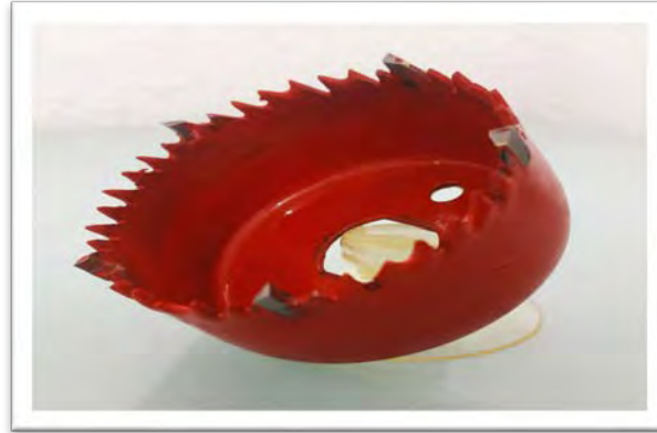
Figura 7. Sierra de copa o sacabocados, modificada con pastillas de carburo de tungsteno (WC).
