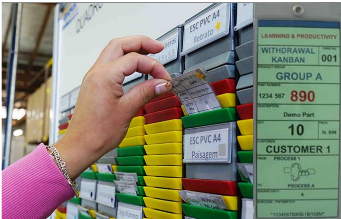
Figura 28. Ejemplo de Tablero y Tarjeta Kanban
