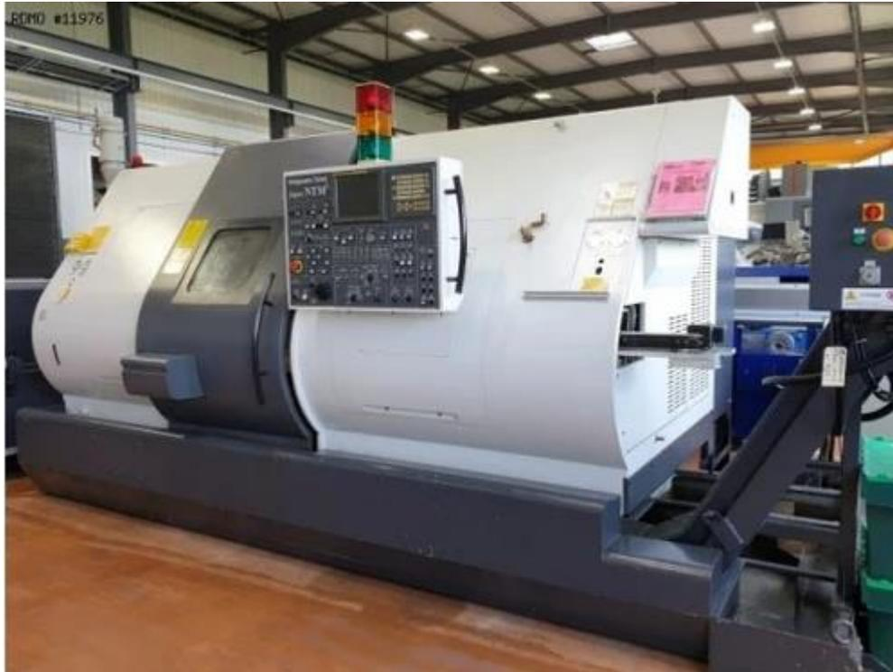
Las máquinas de gran porte cuentan con una computadora dedicada que forma parte del equipo, y la mayoría dispone de un sofisticado sistema de realimentación que monitorea y ajusta constantemente la velocidad y posición de la herramienta de corte.
