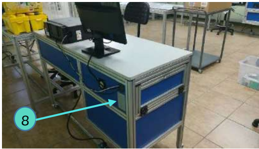
Fig. 59 Contacto Eléctrico a 110 VCA
