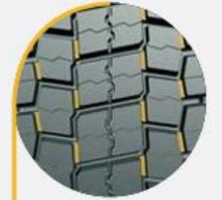
Las barras de unión entre los bloques del dibujo mejoran la estabilidad de la banda de rodadura y disminuyen el desgaste irregular en escalones.
