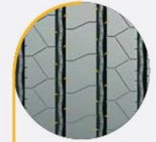
Las laminillas en miniatura en el borde del surco mejoran el rendimiento de tracción y previenen el desgaste irregular.
