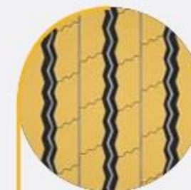
Los bloques anchos de la banda de rodadura aumentan la rigidez del neumático, mejoran su alcance y reducen la resistencia al rodamiento.
