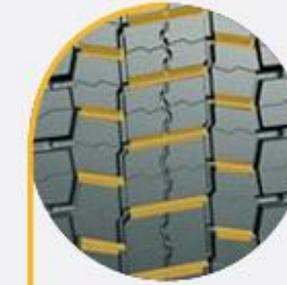
Los surcos horizontales de profundidad completa permiten un drenaje rápido del agua hacia el canal principal, mejorando la tracción en superficies mojadas.
