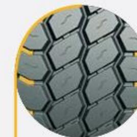
Los bloques de hombro abiertos con puentes evitan el desgaste irregular y proporcionan un excelente rendimiento de tracción en condiciones de carretera y fuera de ella.
