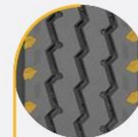
Los salientes en el hombro proporcionan agarre y reducen el calor de la banda de rodadura, lo que prolonga la vida útil de la banda de rodadura.
