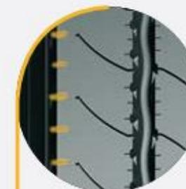
Las laminillas en el hombro alivian la presión en el hombro, previenen el desgaste irregular y prolongan la vida útil de la banda de rodadura.
