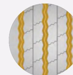
Las ranuras en zigzag junto con una disposición óptima de los bloques proporcionan un rendimiento de tracción mejorado.
