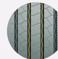
El expulsor de piedras elimina las piedras, previniendo eficazmente las fisuras en el fondo y protegiendo la carcasa.
