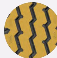
Diseño robusto de cuatro ranuras con una forma especial de surco para combatir la retención de piedras, lo que favorece una mayor duración y capacidad de recauchado.
