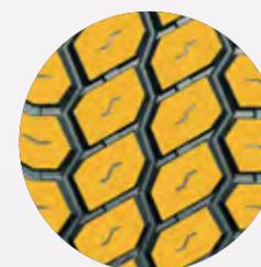
El ancho de la banda de rodadura y las ranuras profundas aseguran una alta durabilidad.
