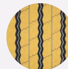
Los bloques de banda de rodadura anchos aumentan la rigidez del neumático y amplían su alcance, reduciendo al mismo tiempo la resistencia a la rodadura.
