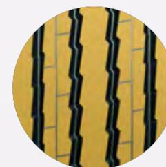
El ancho de la banda de rodadura aumenta el área de contacto con el suelo y mejora el agarre.
