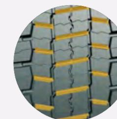
Las ranuras horizontales de profundidad total pueden drenar rápidamente el agua hacia la ranura principal, mejorando el rendimiento de tracción sobre mojado.
