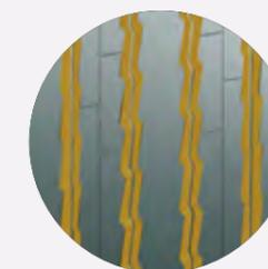
Las 4 ranuras principales en zigzag proporcionan una excelente tracción y rendimiento en drenaje para diversas condiciones de carretera, además de prevenir la retención de piedras y proteger la carcasa.
