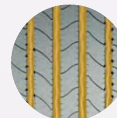
El diseño de ranura recta que se convierte en ranura curva y en onda previene la retención de piedras y protege la carcasa.
