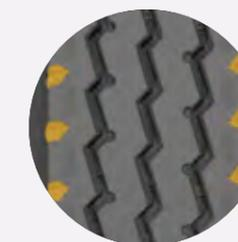
Los tacos en el hombro proporcionan tracción y reducen el calor de la banda de rodadura, prolongando su vida útil.
