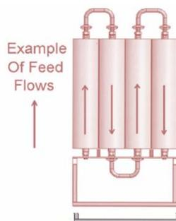
注意: 进料流向可来自ST+膜组件的任意一端, 但必须顺应流动方向来安装膜元件。
