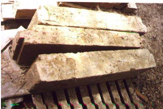
El bambú representa un tipo de armado para la Tierra de gran interés debido a su bajo coste económico y medioambiental, a su facilidad de obtención, su alta resistencia, su amplia distribución geográfica, y la posibilidad de poder sustituir al acero en elementos traccionados o a flexión. Como inconvenientes resalta el cambio dimensional que experimenta el bambú al absorber humedad, hinchándose durante el curado del hormigón, comportando la fisuración del elemento antes que éste entre
