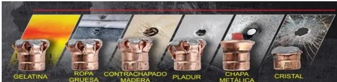
Expansión de un proyectil de punta hueca Hornady Critical Duty<sup>7</sup> tras atravesar diferentes materiales.
