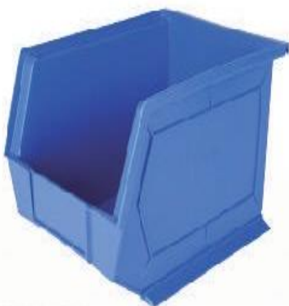
Gaveta 6 L: 300 An: 200 Al: 160 mm Capacidad 12 kg Apilable HDPE virgen
