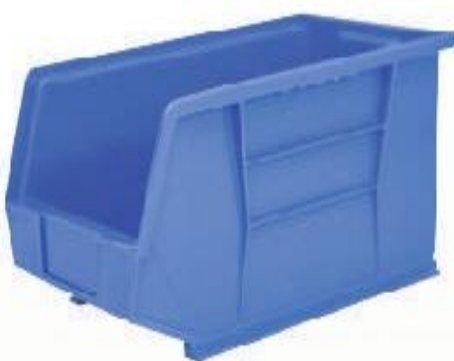
Gaveta 5 L: 280 An: 165 Al: 130 mm Capacidad 7 kg Apilable HDPE virgen
