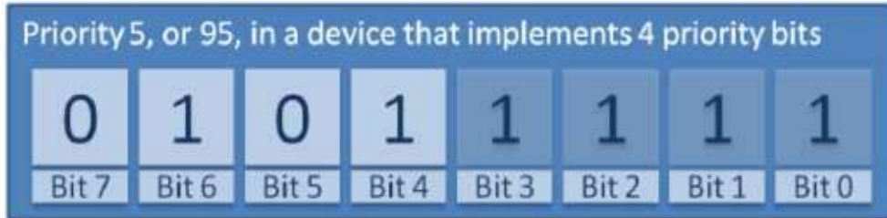
Şekil 7.15 İkili 101 önceliğinin, dört öncelik biti uygulayan bir Cortex-M mikrodenetleyici tarafından nasıl saklandığı
