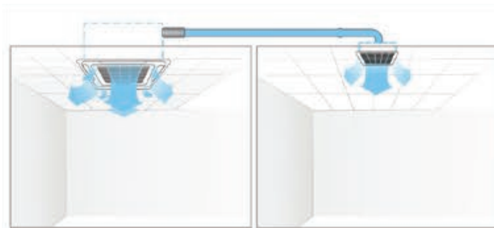
Ducto de aire externo
