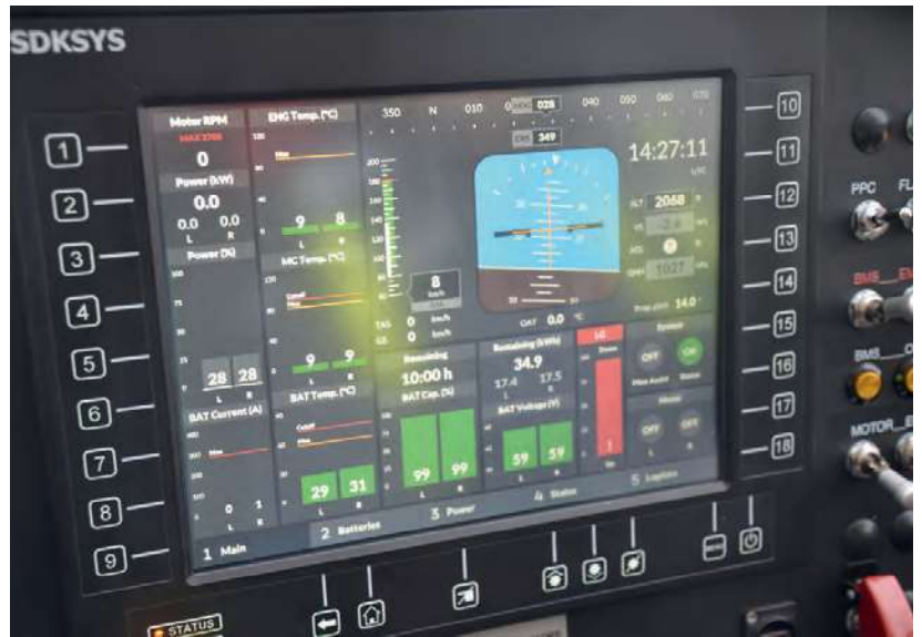
L'ordinateur de bord, outre la navigation et le moteur, gère le système DAP qui surveille, enregistre, et transmet en temps réel tous les paramètres.
