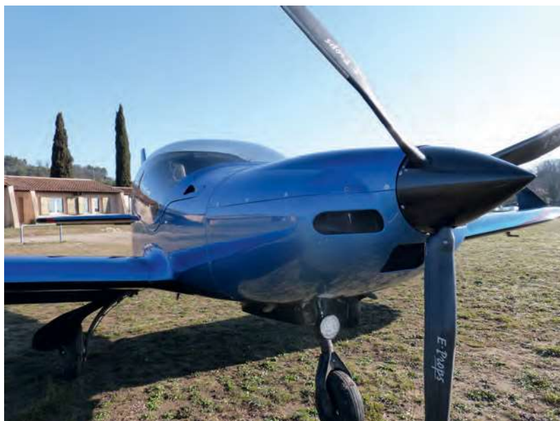
Le Blackwing est équipé d'une Glorieuse tripale à pas variable fabriquée par E-Props.
