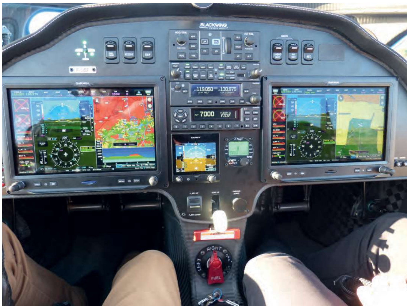
Entre les deux Garmin G3X sont installés le panneau de commande du pilote automatique, le mélangeur audio, la VHF, le transpondeur, puis le Garmin G5 de secours et le régulateur de régime E-Props. En dessous, l'interrupteur des volets, la commande du train rentrant, et le frein de parking, puis la poignée du parachute et le sélecteur de réservoir.
