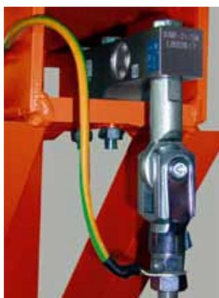
Celdas de carga electrónicas
