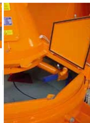
La probada mezcladora planetaria de contracorriente HPGM, el pupitre de control y la báscula de cemento con celdas de carga electrónicas y el contador de agua vienen ya instalados y están completamente integrados en la plataforma de la planta SmartMix. Compuertas grandes de acceso y una plataforma amplia permiten un mantenimiento seguro para asegurar un funcionamiento perfecto de la máquina.
