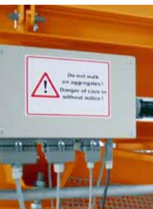
Caja de terminales con conexión de enchufe
