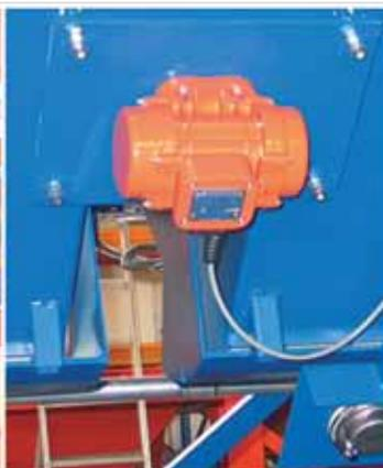
Silo en fila: compuertas para dosificación gruesa y fina, cintas de dosificación, vibrador y sonda de medición de la humedad „Hydrotester“ (Opción)
