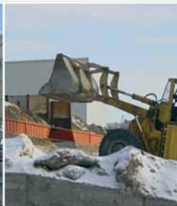
Carga del silo en fila: sistema de carga automático, alimentación con cargadora de pala
