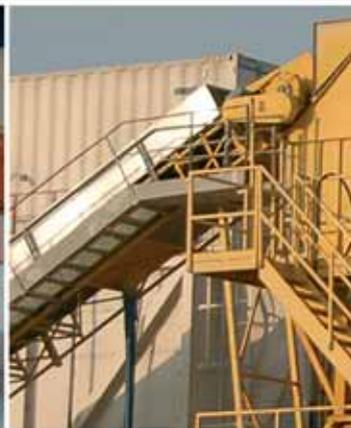
Carga de la mezcladora: cinta de transporte inclinada, báscula de elevador de carga
