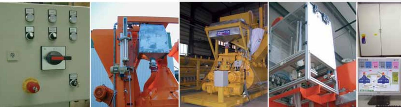
Plataforma de la mezcladora: Mezcladora con báscula de cemento y báscula de agua (como alternativa, adición del agua mediante contador de agua); DWM – la alternativa a la HPGM con báscula de hielo, báscula de agregados
