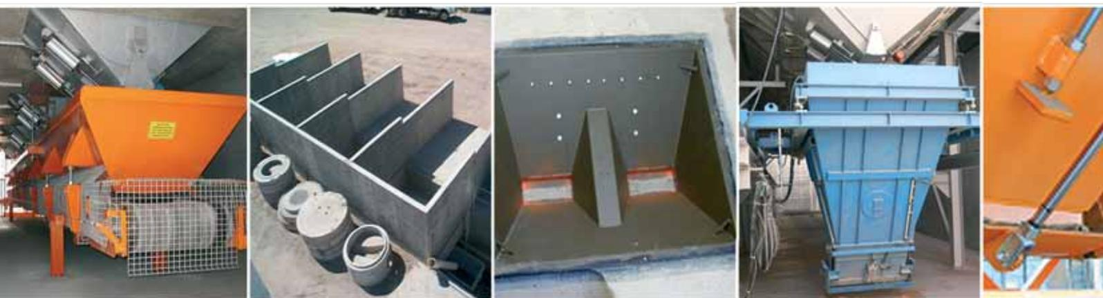
Pesaje de agregados: silo de agregados opcional hecho de concreto, con cinta de pesaje colgada del techo y conos de dosificación para una dosificación gruesa/fina, báscula desplazable – la alternativa a la cinta de pesaje
