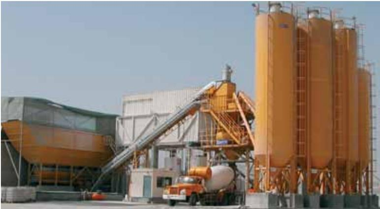
Mezcladora DWM - Probada en la industria de concreto premezclado y de concreto prefabricado. MobilMat Mo 120 con mezcladora de doble eje.
