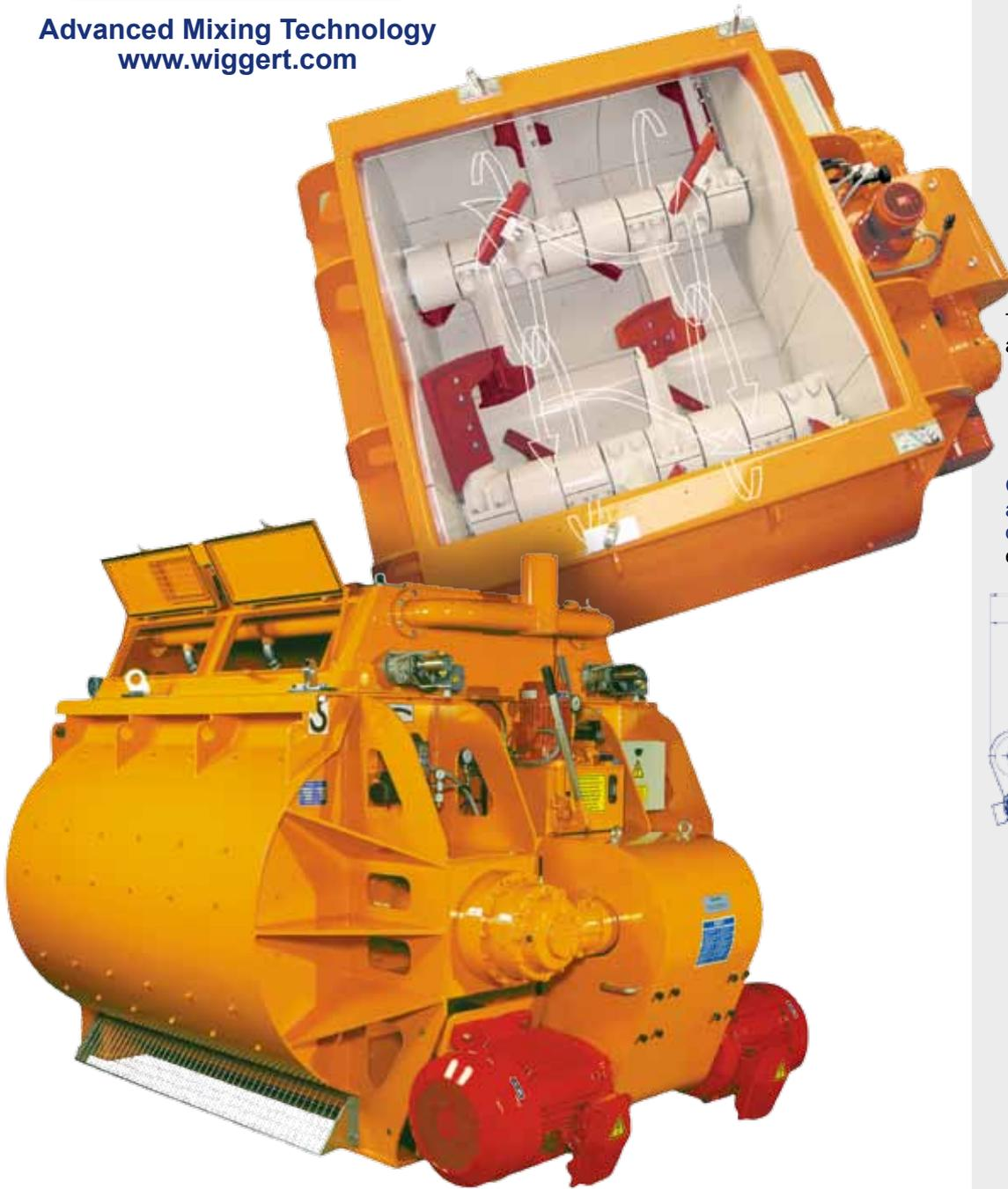
Fondo de la mezcladora con chapas de blindaje resistentes al desgaste para una duración más larga
