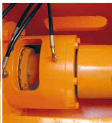
Sistema lubricador central y automático
