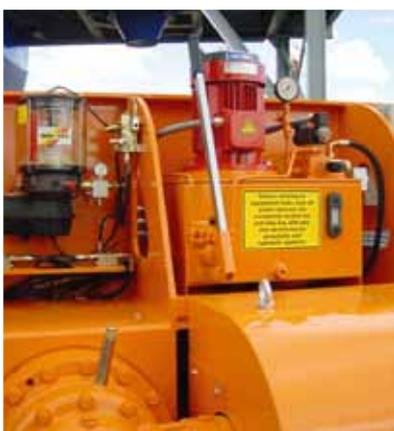
Unidad hidráulica para el accionamiento de la compuerta de descarga
