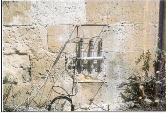
Şekil 5. Yassı krik (Flat-Jack) test çalışmaları (FSM, KURAM)
