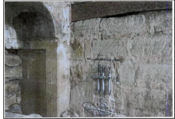
Şekil 5. Yassı krik (Flat-Jack) test çalışmaları (FSM, KURAM)
