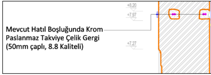
Şekil 16. Kot 3 ve kot 4 takviye detayı
