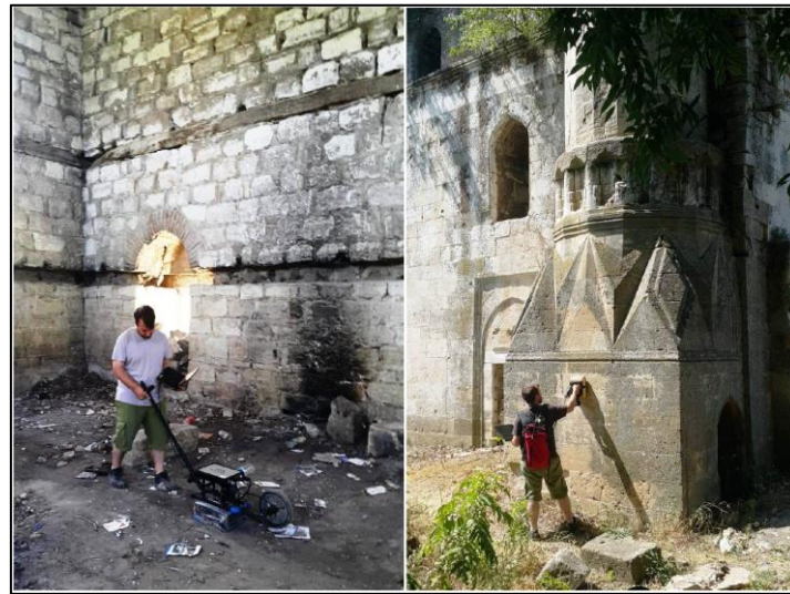
Şekil 6. Yeraltı radar (GPR) ve tarama çalışmaları
