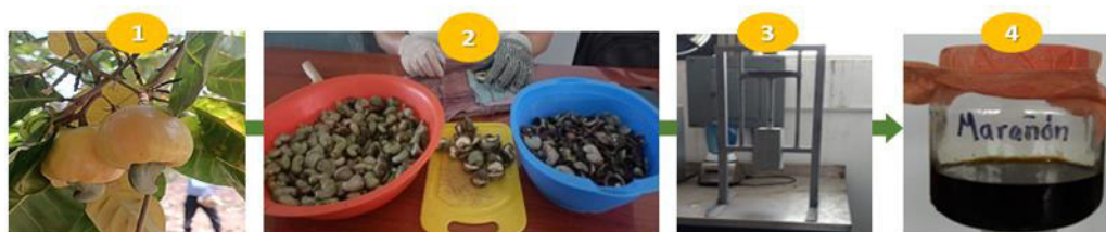
Figura 2. Proceso de extracción del CNSL mediante prensado a partir de cáscaras de anacardo.
