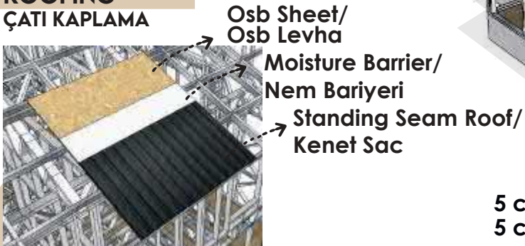
ROOFING ÇATI KAPLAMA
