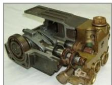
Bomba de cigüeñal y bielas, que es de mucho mejor calidad y de un uso mas rudo que una bomba axial o de plato inclinado, con resortes.
