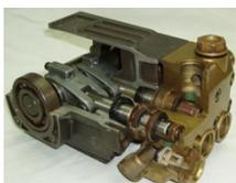
Bomba de cigüeñal y bielas, que es de mejor calidad y de un uso mas rudo que una bomba axial o de plato inclinado, que usa resortes.
