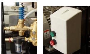
Válvula by - pass industrial, Filtro agua de uso rudo como todos sus componentes y arrancador con protector bimetálico, uso industrial a 220 V ó 440 V.
