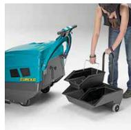
El contenedor de basura posterior, gracias a una mayor capacidad, permite reducir los tiempos necesarios para su vaciado. Está montado sobre ruedas y equipado con una cómoda manija que facilita las operaciones de descarga.
