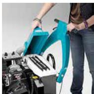
El polvo más fino es filtrado por un filtro de saco de poliéster con un excelente grado de filtración (99,9%) y tiene una duración mucho más larga que la de los filtros tradicionales. El filtro se limpia por medio de un eficaz sacudidor mecánico.
