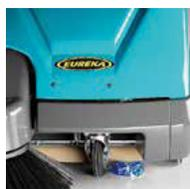
La máquina está equipada con un dispositivo de "elevación de faldones" en la parte anterior, que facilita la recogida de los residuos voluminosos.
