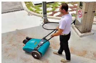
Cuando se empuja la máquina, hacia delante o atrás, la rueda lateral transmite el movimiento al cepillo central y, además, activa un árbol de transmisión que está conectado a la turbina la cual capta el polvo que se levanta durante el trabajo de limpieza.
