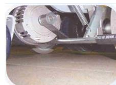
El nuevo jalador está hecho de aluminio forjado y esta diseñado para optimizar la succión y simplificar el cambio de los hules. Puede ajustarse fácilmente para proporcionar un secado perfecto en cada superficie, los hules jaladores son reversibles y se pueden usar en los cuatro lados.
