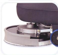
El depósito inferior hace de elemento portante y permite eliminar al chasis metalico tradicional.
