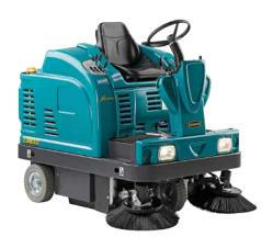
**MODELO** XTREMA DK Ancho de barrido con cepillos laterales 1.400 mm Ancho de barrido con cepillo central 800 mm Capacidad cajón de basura 150 Kg Altura de descarga con mando hidráulico 1.360 mm Velocidad de avance 9,00 km/h Productividad horaria 12.600 m<sup>2</sup>/h Tipo de filtro de saco, de poliéster Tracción hidráulica hidráulico Motor tracción Motor (cantidad / V / Watt) Kubota 14 Hp
