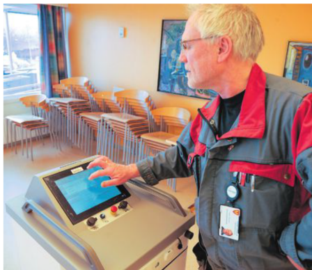
OPERATØR: Hjelpemiddeltekniker Tommy Sørensen er en som primært opererer roboten Decon X. – Den må vite hvor stort rommet den skal desinfisere et, men vi har lagt inn kubikkmetre på alle rommene i maskinen nå. Så det er bare å finne rett rom, tette alle luftinntak for bruk og sette den på. Det tar fem minutter, forteller han om roboten. FOTO: TORGRIM GOTLAND BAKKE
