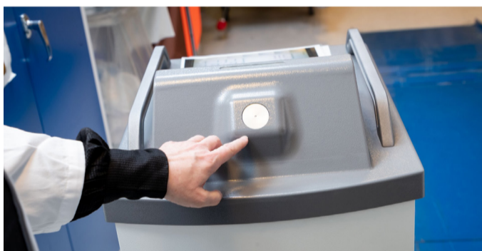
Fra dette hullet siver hydrogenperoksidgassen ut i rommet og desinfiserer sengene. Foto: Werner Juvik
