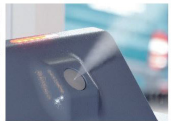
DESINFISERING: Roboten sprøyter ut hydrogenperoksid, som skal ta knekken på tilnærmet 100 prosent av sykdomssmitte i rommet.
