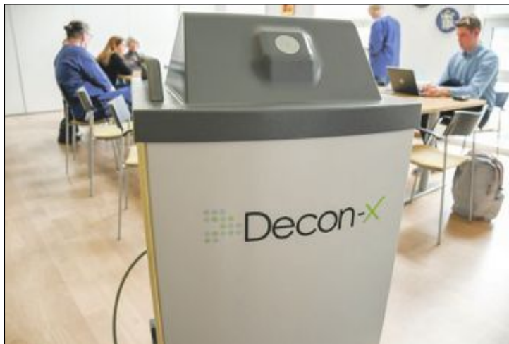
99,999 PROSENT: Roboten desinfiserer rom ved hjelp av hydrogenperoksidgass. Etter prosessen skal 99,999 av alle bakteriar og sporar vera borte. Slik håpar kommunen å halda bebuarar og tilsette friske gjennom til dømes influensasesonane.
