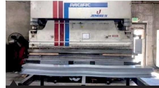
Press Brake de 14' y 220 tons CNC.
