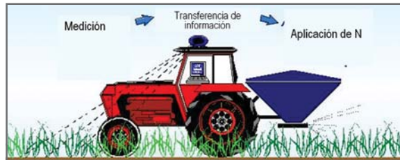
Figura 1.4: Sensor en tiempo real para la aplicación de nitrógeno con dosis variable (Yara, 2005)
