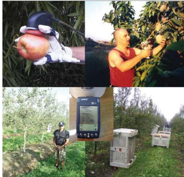
Figura 3.14: Monitores experimentales de calidad de fruta. Localización espacial de los bins de cosecha en los huertos, mediante uso de lectores de código de barra y localización según cuartel, hilera y árbol.
