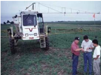
Figura 6.21: Pulverizadora autopropulsada "Smart sprayer" equipada para identificar y controlar malezas desarrollada por la Universidad de Illinois (UIUC, 2005).
