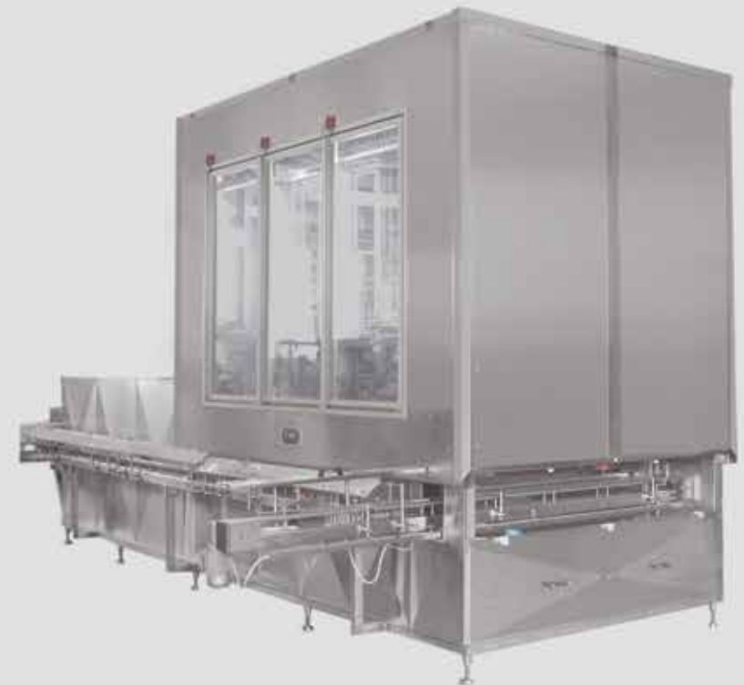
Tunnel di raffreddamento realizzati nelle versioni orizzontali e verticali a seconda delle caratteristiche del prodotto
