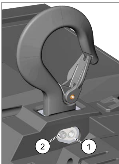
Figura 5. Retentor do pino de suspensão/parafuso retentor
