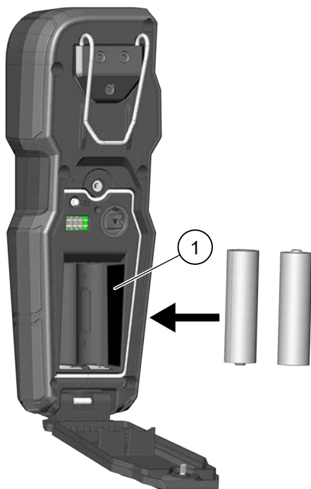
Figura 1. Instalação de baterias do controle remoto
