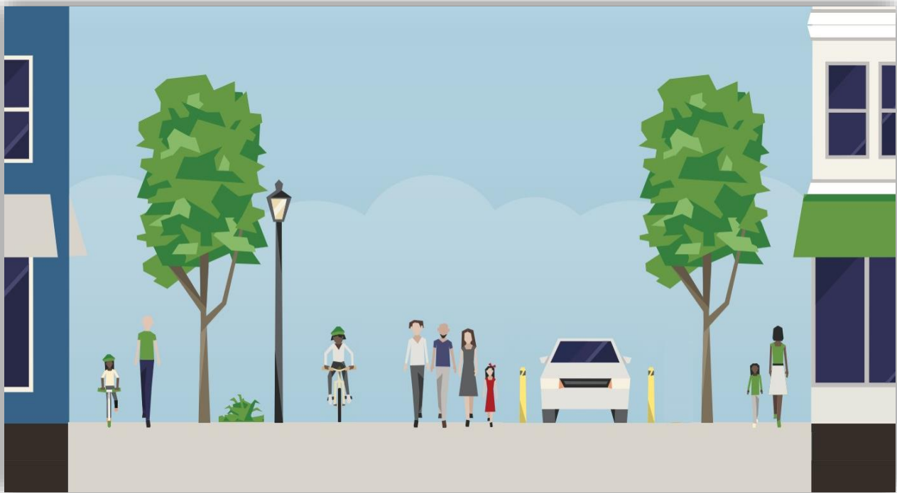
Figura 43. Sección tipo de vía de prioridad peatonal
