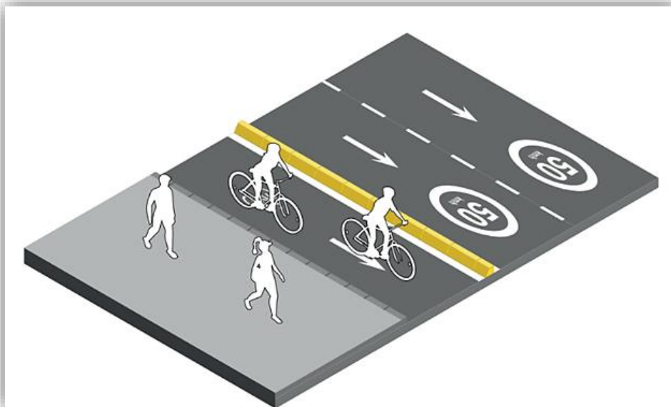
Figura 12. Elementos básicos de una ciclovía unidireccional
