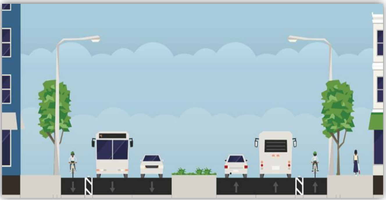
(Continúa) Figura 13. Sección tipo de ciclovía unidireccional en avenida de doble sentido con separador central
