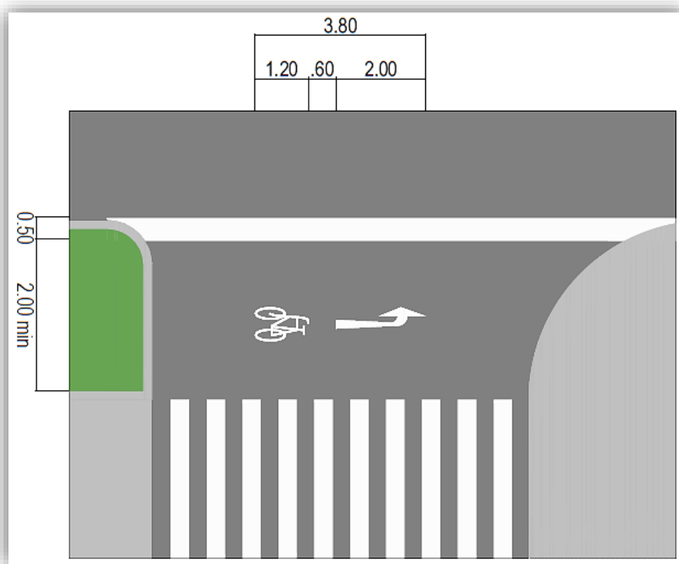
Figura 56. Vuelta izquierda a través de la caja bici de giro
