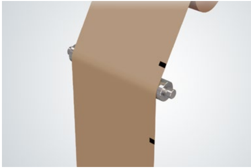
Detección de marcas de registro en películas
