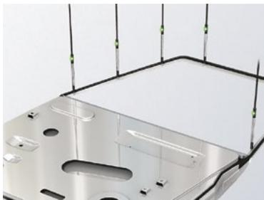
Verificación de la deformación del marco de una puerta
