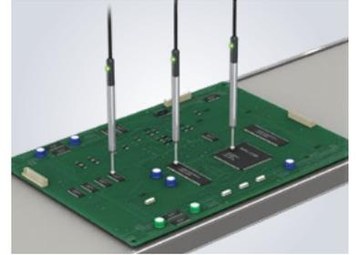
Inspección del ensamblaje de tarjetas
